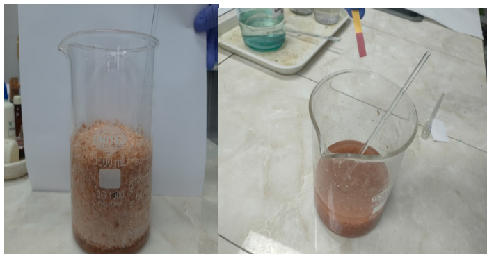
Рисунок 4 – а) наблюдение выделение газа ( \text{CO}_2 ) при добавлении \text{HCl} ; б) индикатор доказывает наличие кислотной среды
