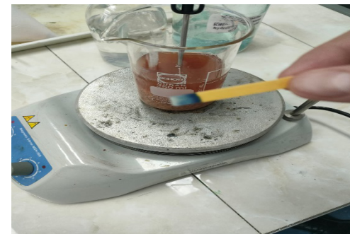
Рисунок 6 – Добавление \text{NaOH} ; индикатор доказывает наличие щелочной среды
