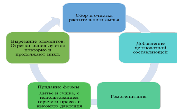
Рисунок 1- Цикл изготовления одноразовой биоразлагаемой посуды из растительного сырья.
